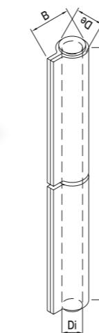
**I** Cerniera in ferro a saldare a 3 ali chiuse con perno sfilabile grezza
